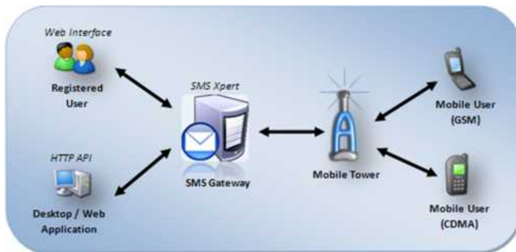
Gambar 8. Mekanisme kerja SMS Gateway
