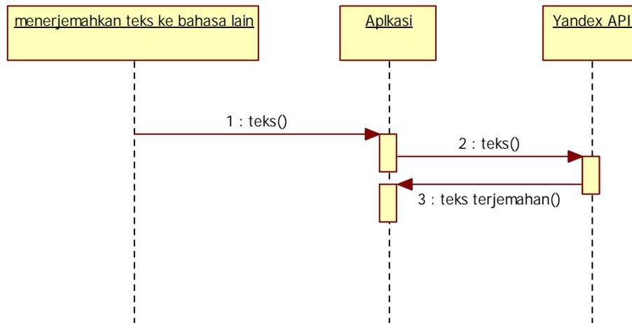
Gambar 13. Sequence Diagram menerjemahkan teks ke bahasa lain
