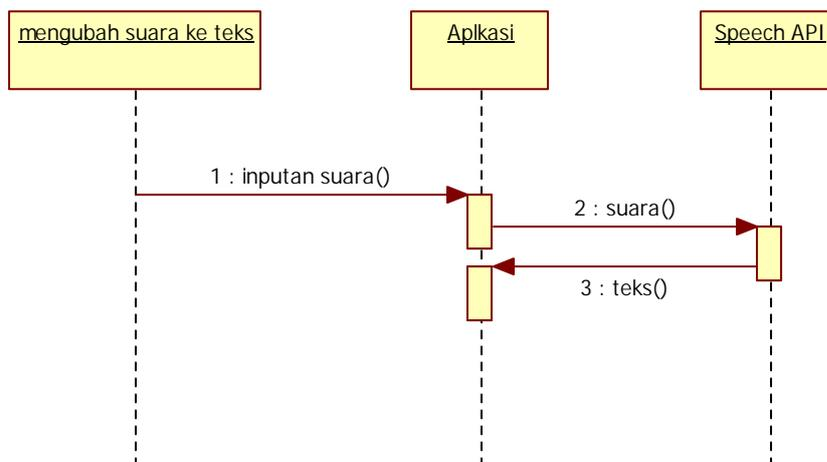
Gambar 12. Sequence Diagram mengubah suara ke teks
