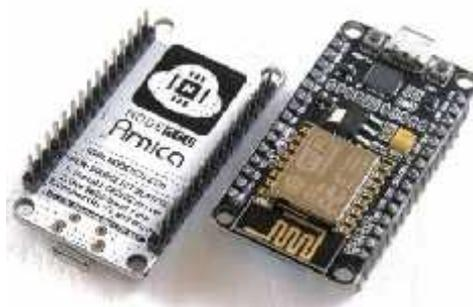
Gambar 1. Nodemcu Amica ESP8266
