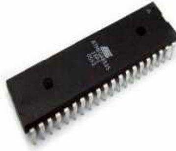
Gambar 2.1 MikrokontrolerATMega8535
