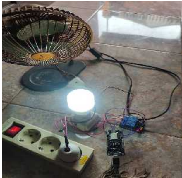
Gambar 9 Hasil relay 1 menyala : Lampu
