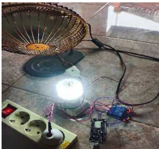
Gambar 12 Hasil relay 1 dan 2 menyala : lampu dan kipas angin
