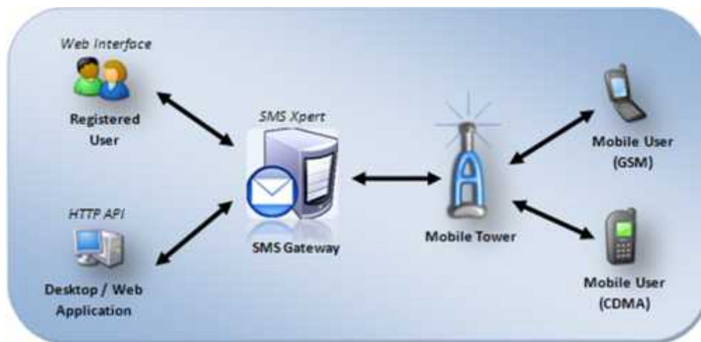
Gambar 8. Mekanisme kerja SMS Gateway
