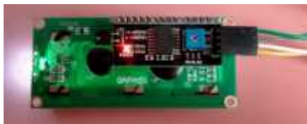
Gambar 15. Pengujian Liquid Crystal Liquid dengan I2C
