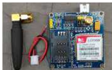
Gambar 3 Modul SIM 900 A
