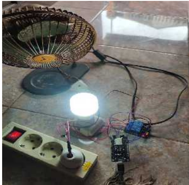
Gambar 9 Hasil relay 1 menyala : Lampu
