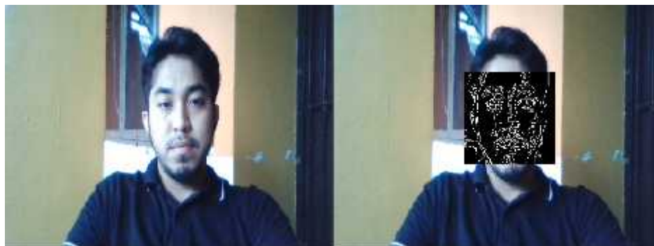
Gambar 6. Deteksi tepi pada area wajah
