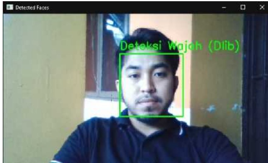
Gambar 7. Deteksi wajah menggunakan dlib
