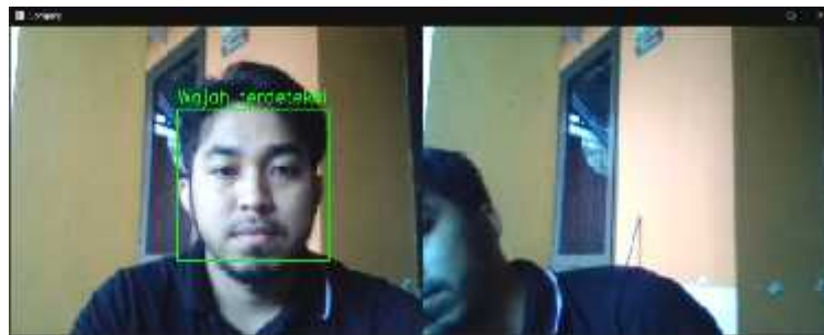
Gambar 3. Deteksi wajah menggunakan haarcascade
