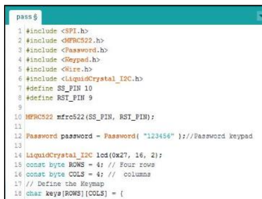
Gambar 6. Listing Program untuk Pemberian kode PIN pada Keypad
