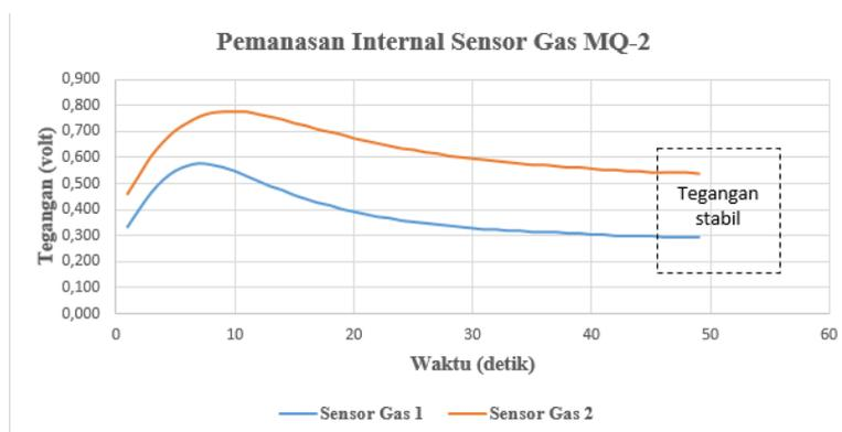
Gambar 3 Grafik pemanasan internal sensor gas MQ-2
