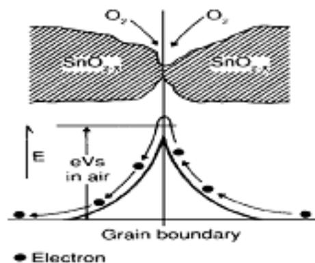
Gambar 1 Model inter-grain potensial penghalang saat tidak ada gas[7]
