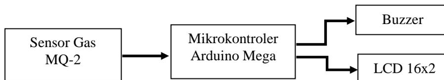
Gambar 1 Diagram blok sistem pendeteksi gas
