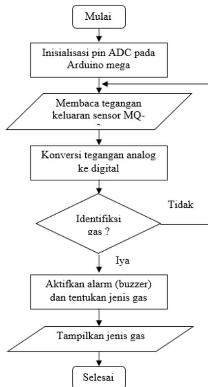
Gambar 2 Diagram alir rancangan perangkat lunak sistem pendeteksi gas
