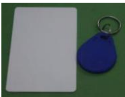
Gambar 2.1 Bentuk RFID Tag (Kiri-Card, Kanan-Key Chain) (Sumber: Arsip Pribadi)
