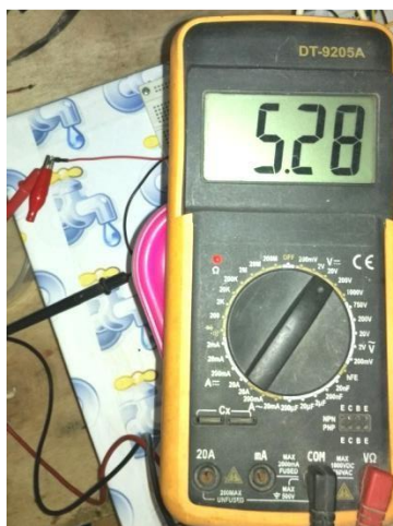
Gambar 4. Pengukuran tegangan Volt DC
