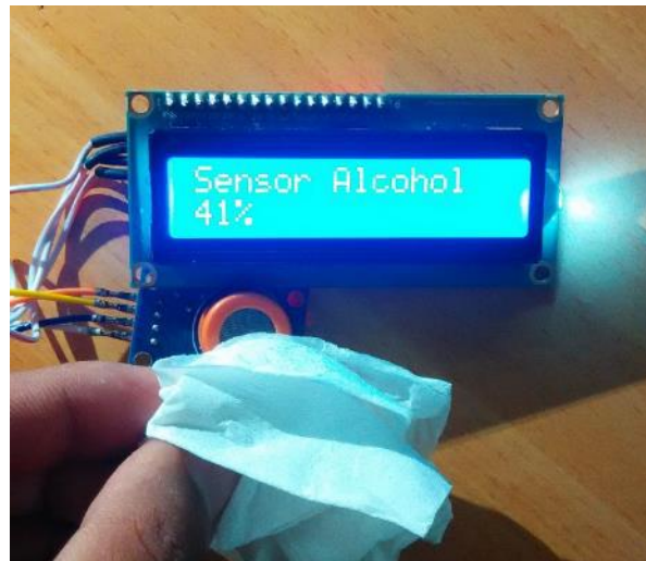
Gambar 3.3 Pengujian pada sensor MQ-3 dan LCD 16x2
