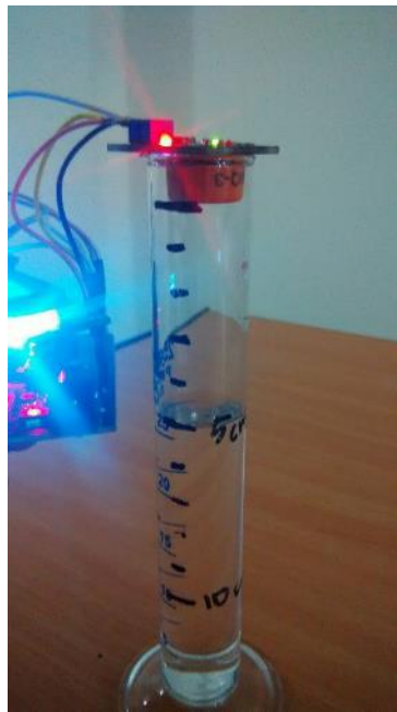
Gambar 3.11 Pengujian Jarak Pada Sensor MQ-3
