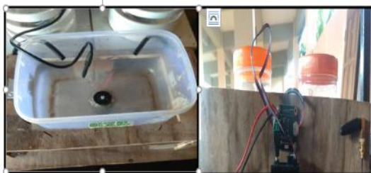
Gambar 9. Pemasangan Sensor TDS Meter
