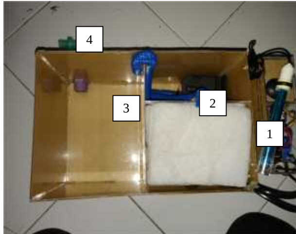
Gambar 5 : Bak Penampungan Limbah yang dipasang sensor deteksi kandungan limbah
