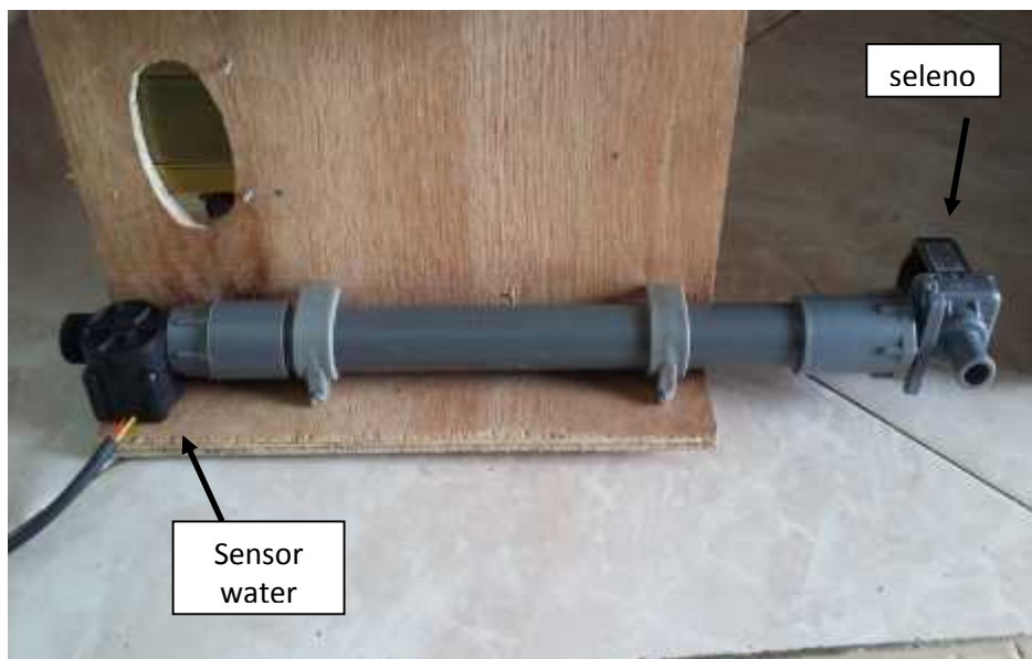
Gambar 7.1. Pemasangan dan Sensor Water Flow
