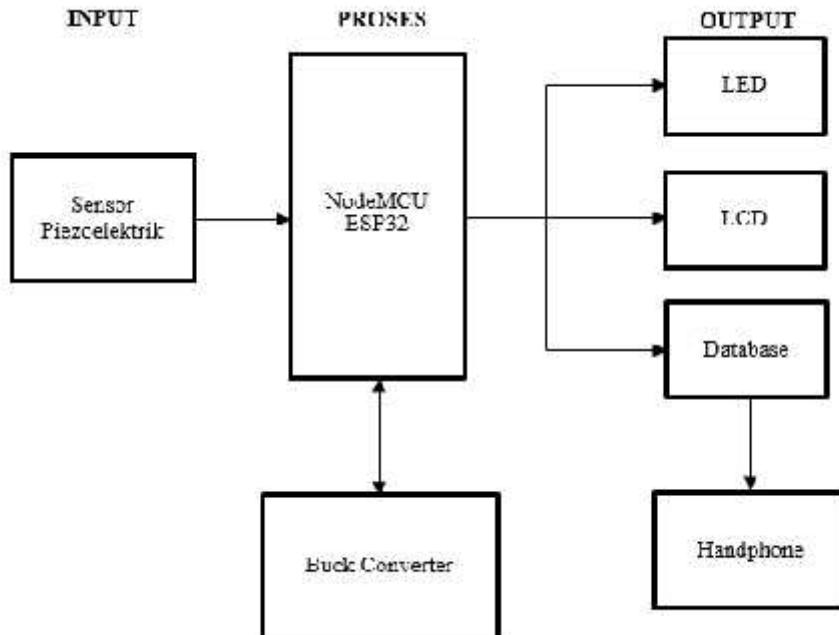
Gambar 1 Blok Diagram
